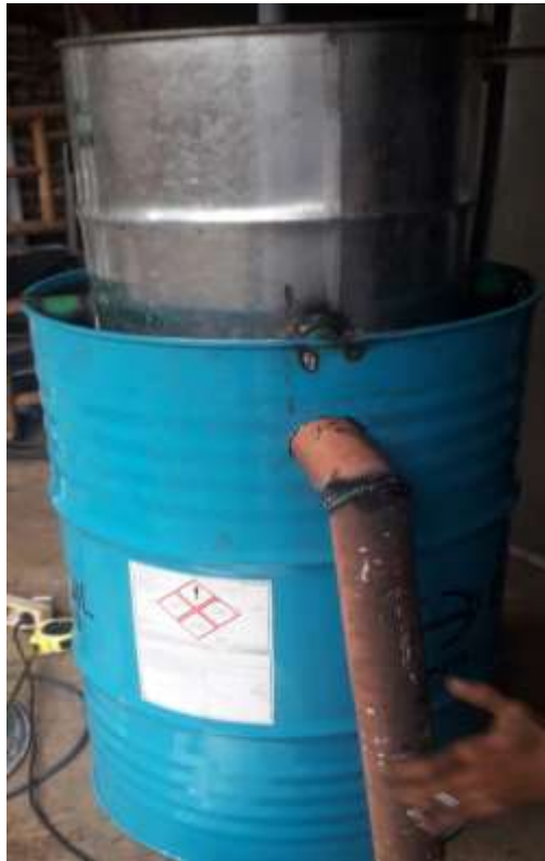
Gambar 7. Penggabungan pipa besi dengan drum
