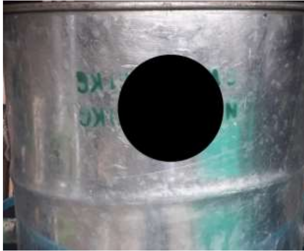
Gambar 8. Pembuatan lubang pada drum 150 liter
