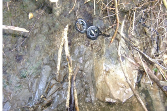
Gejala struktur geologi berupa breksiasi pada Batulempung dan Batupasir
