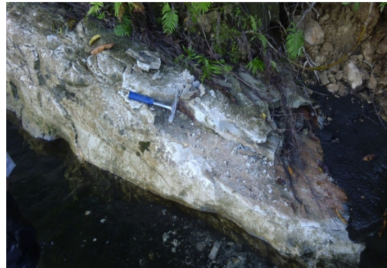
Singkapan batulempung sisipan batupasir yang mewakili Formasi Kukunduri (Qpk) , kedudukan batuan N 315° E/ 45° tersingkap di sungai Tor bagian tengah dengan koordinat S 02° 22' 32,0" dan E 138° 41' 06,8".
