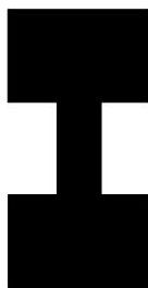
Gambar 1 : Dumbbell-shape DGS pada groundplane mikrostrip
